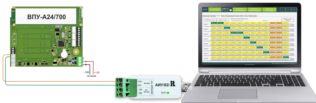
Рисунок 126. Схема подключения для конфигурирования ВПУ-A24/700
