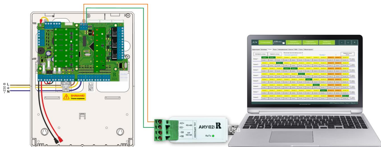
Рисунок 126. Схема подключения для конфигурирования ВПУ-A24/700
